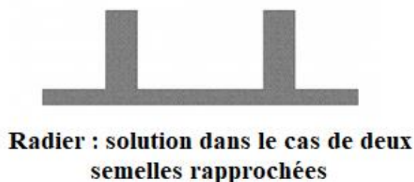
Figure 3.8 : Risque de chevauchement des semelles
