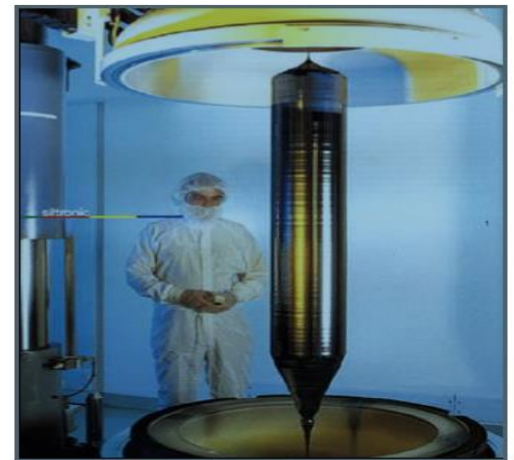
Figure II-2 : Lingot monocristal de Si de 300mm de diamètre et de 1m de longueur.
