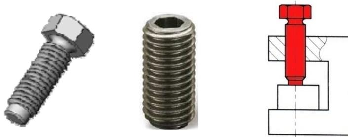
**Figure 2.5-** Assemblage par une vis de pression.
