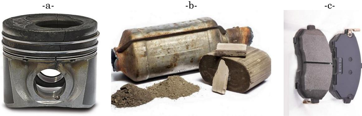
**Fig.4.3.** Type de défaillance : a- Défaillance critique (Rupture du piston et des segments), -b Défaillance majeur (d Problème Catalyseur) et c- Défaillance mineur (problème des plaquettes de frein).
