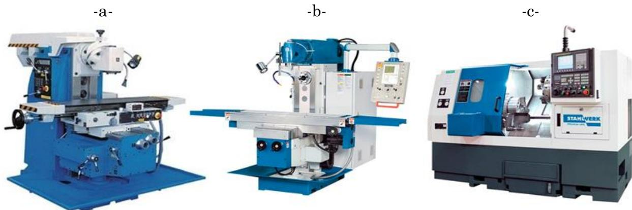
**Fig.3.2** Le matériel de production : a- machines manuels, b- machines semi-automatiques et c- machines automatiques.
