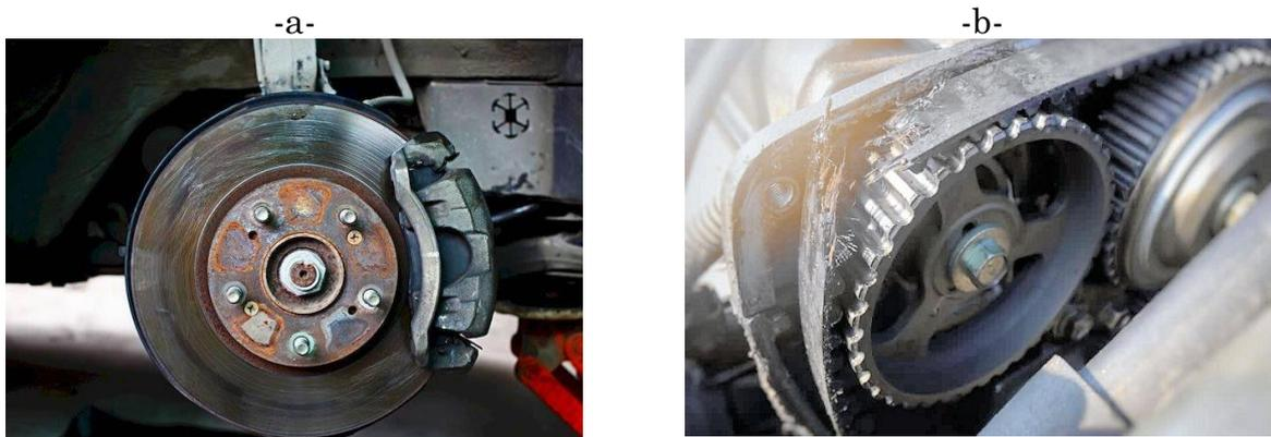
**Fig.4.1.** Type de défaillance : a- Défaillance progressive (disque de frein d'une voiture) et b- Défaillance soudaine (chaîne de distribution d'une voiture).
