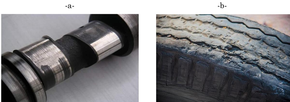
**Fig.4.5** Mécanisme d'usure : a- arbre à came usé et b- L'usure des pneus
