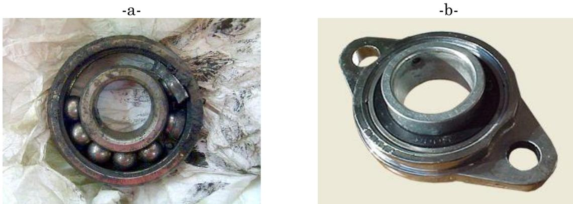
**Fig.4.2.** Type de défaillance : a- Défaillance intrinsèque (grippage d'un roulement à billes), -b Défaillance extrinsèque (détérioration d'un palier à la suite du blocage d'un roulement pour cause de grippage).
