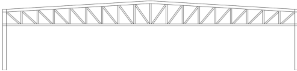
Figure 5.6: Portique avec traverse en treillis.
