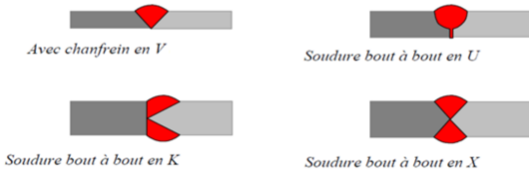
Figure 8.12 : Soudures bout à bout.
