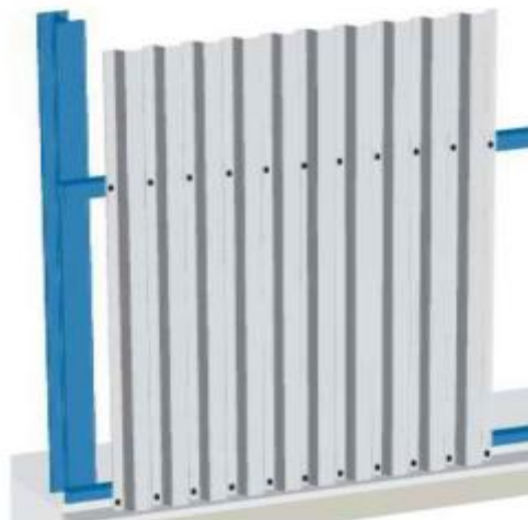
Figure 3.5 : Illustration de la fixation d'un bardage simple peau
